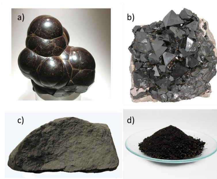
Rysunek 6 Zdjęcia tlenków żelaza: a) hematyt, b) magnetyt, c) maghemit, d) wustyt. 27,28,29,30
