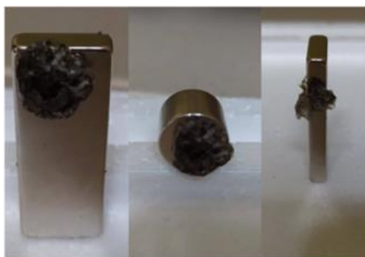
Rysunek 75. Zdjęcia prezentujące hydrożel przyciągnięty do magnesu stałego.
