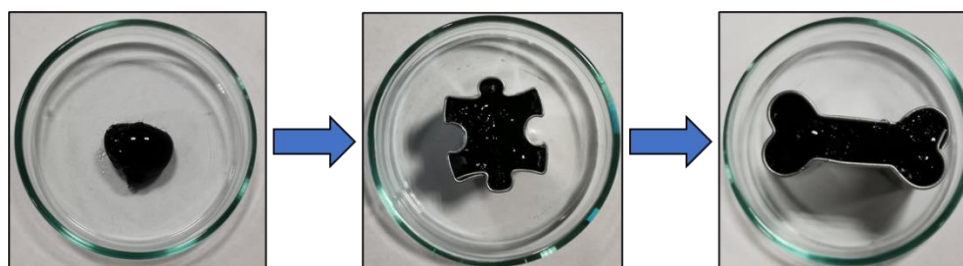
Rysunek 66. Hydrożel ColCh z możliwością dopasowania się do kształtu ubytku.
