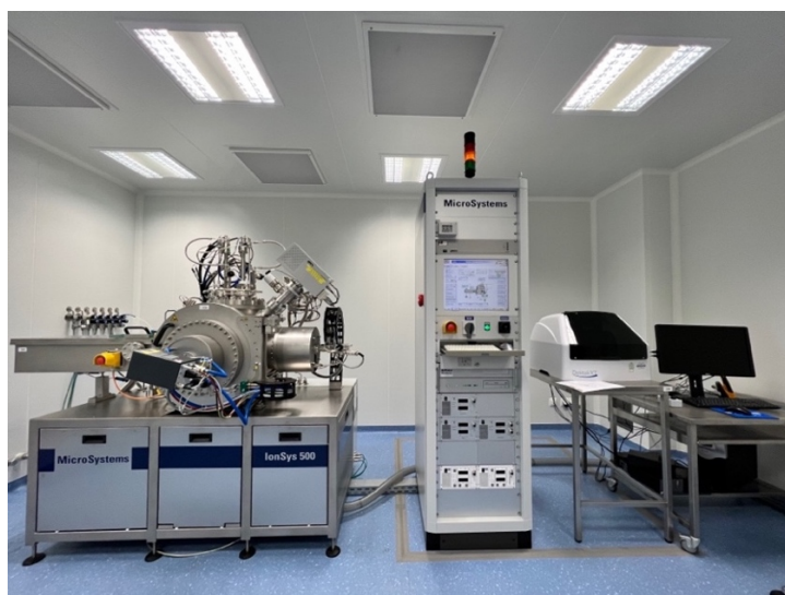
Rysunek 33. Pomieszczenie cleanroomu o klasie czystości 1000, wyposażone w magnetron, działo jonowe oraz detektor masowy, a także profilometr.
