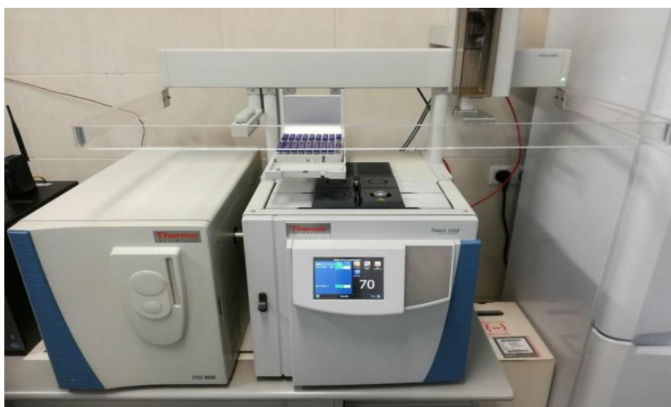
Rysunek 24. Chromatograf gazowy ze spektrometrią mas Trace 1310 Gaz Chromatograph, ITQ 900 Mass Spectrometer, [materiał własny]
