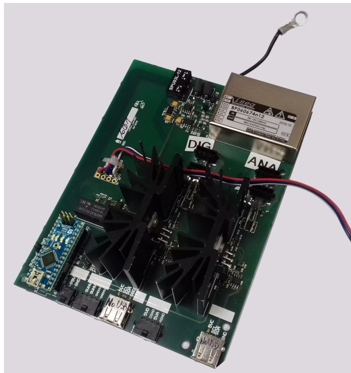
Rys. 2.25: Zdjęcie modułu zasilającego z układem Arduino Nano.
