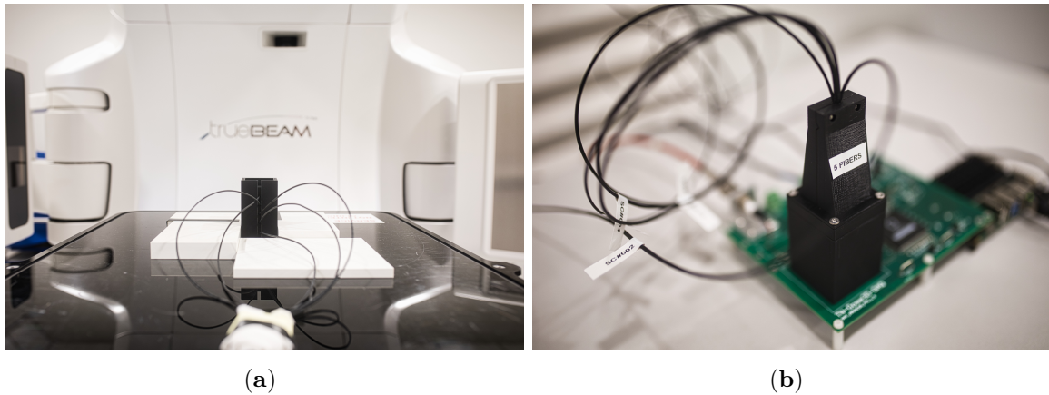
Rys. 4.39: Ułożenie prototypowego fantomu na stole do naświetlania TrueBeam™ (a), oraz jego połączenie z Jednostką Akwizycji Danych (b), która znajdowała się obok stołu poza bezpośrednim oddziaływaniem wiązki promieniowania z akceleratora. Elementy mechaniczne umożliwiające połączenie scyntylatorów z MA-PMT oraz zapewniające nieprzepuszczalność otaczającego światła zostały wykonane metodą druku 3D.
