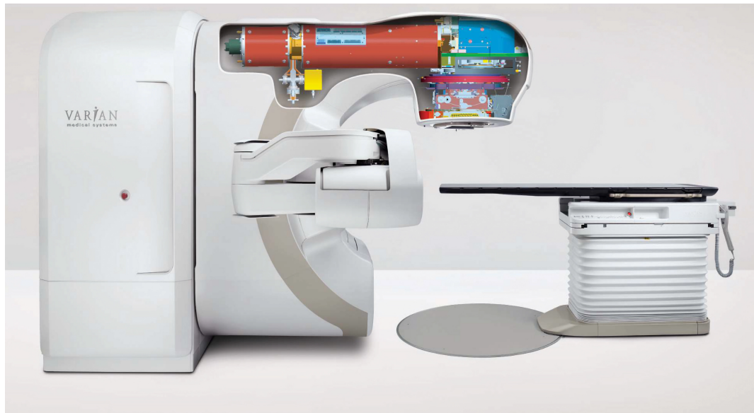
Rys. 1.17: Wizualizacja techniczna komponentów składowych urządzenia TrueBeam TM . Akcelerator liniowy znajduje się w górnej części grafiki. Promieniowanie fotonowe lub elektro- nowe jest odpowiednio kształtowane przez filtry oraz MLC i jest kierowane w stronę zmian chorobowych u pacjenta znajdującego się na stole. Zaadaptowane z [139].
