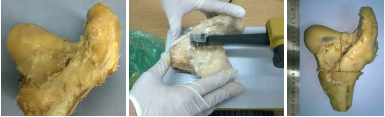
Rysunek 3.4. Zdjęcia końca bliższego wołowej kości udowej przed pocięciem (po lewej), w trakcie cięcia (w środku) oraz po przecięciu w celu uzyskania fragmentów nadających się do pomiaru \mu CT w skali makro (po prawej), z widoczną linijką dla pokazania skali).
