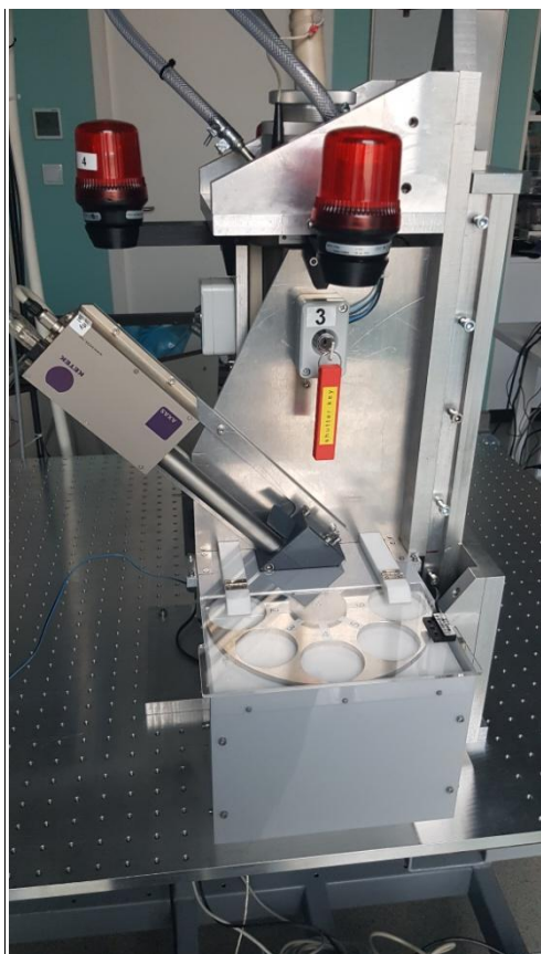
Rysunek 7. Spektrometr EDXRF – talerz zmieniający próbki.
